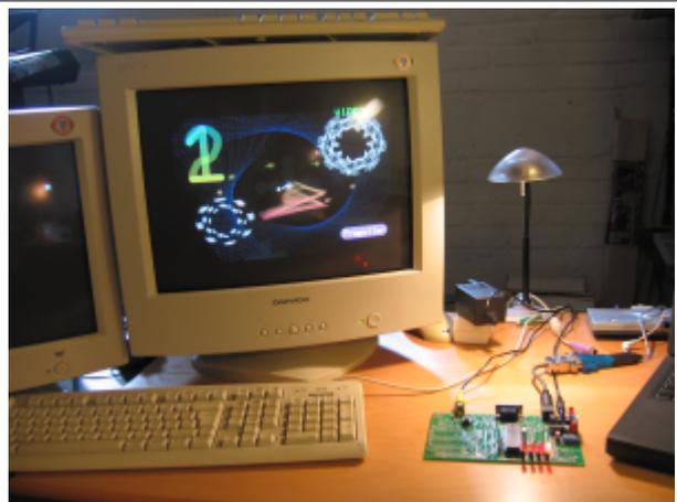
Wer einen TV zur Verfügung hat sollte den Videoausgang testen. An diesem liefert der Propeller bei entsprechender Programmierung ein Composite-Video-Signal, welches man am Fernseher darstellen kann, sofern dieser über eine SCART-Buchse verfügt. Sollte dabei nur ein monochromes Bild erscheinen, liefert die Software ein NTSC-Signal. Die
